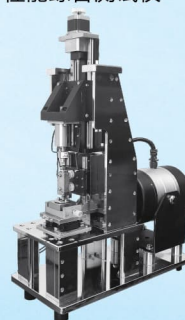
WDF-300高频微动 摩擦磨损试验机
