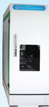
超高温水氧环境 摩擦磨损测试系统
